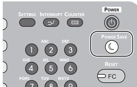
El dispositivo está equipado con 3 modos de ahorro de energía: modo ahorro de energía, modo reposo y modo súper reposo. Los procedimientos para cambiar a cada modo y sus condiciones de recuperación están descritos en la siguiente tabla.
