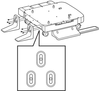
Coloque el tornillo en el centro del orificio ovalado y apriételo.
