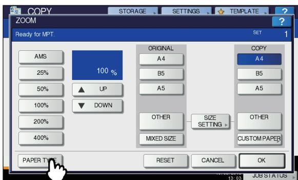
**10 Pulse el botón de tipo de papel que se corresponda con el papel colocado en la bandeja multiuso. A continuación, pulse [ACEPTAR(OK)].**
